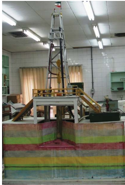
شکل ۴: بازسازی لایه های مختلف زمین و شبیه سازی چگونگی حفاری این لایه ها (آزمایشگاه اداره زمین شناسی شرکت ملی مناطق نفتخیز جنوب)
