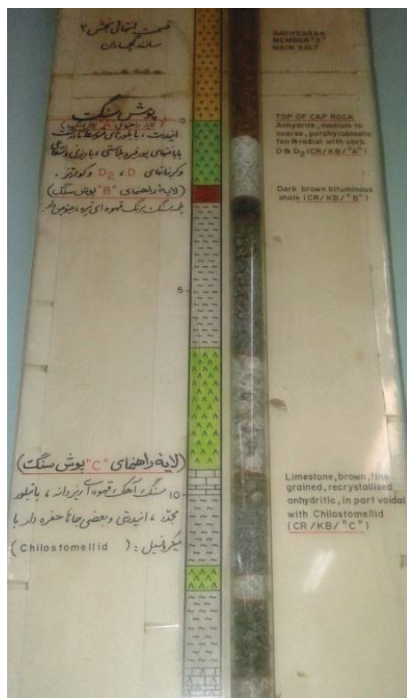
شکل ۶: شبیه سازی سازند های زمین شناسی ستون یک چاه براساس خرده های حفاری هر سازند با مقیاس مشخص در یک لوله
