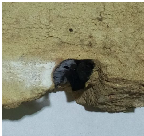
شکل ۴- تاثیر اشعه لیزر با توان ۶ کیلو وات در دو نمونه آهکی (الف) و سیلیسی (ب)
