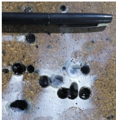
شکل ۵- حفاری لیزری تکفام با توان ۶۰۰ وات
