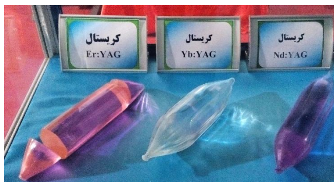
شکل ۳- ترکیب کننده های لیزری به دو صورت کریستال و میله ای
