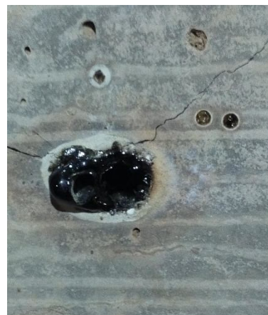
شکل ۴- تاثیر اشعه لیزر با توان ۶ کیلو وات در دو نمونه آهکی (الف) و سیلیسی (ب)
