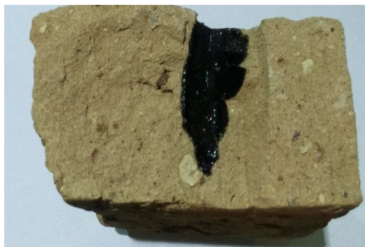
شکل ۱- ذوب شدن بلورهای سیلیس در ماسه سنگ بر اثر برخورد اشعه لیزر
