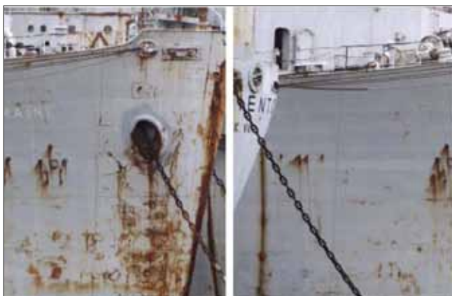
شکل ۱۱ | نمایی از خوردگی‌های میکروبی روی بدنه‌ی نفتکش‌ها بر اثر چسبیدن جلبک‌ها [۲۰]
